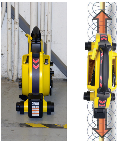
Рисунок 12 – Ориентировочные стрелки, выравненные вдоль проводника
