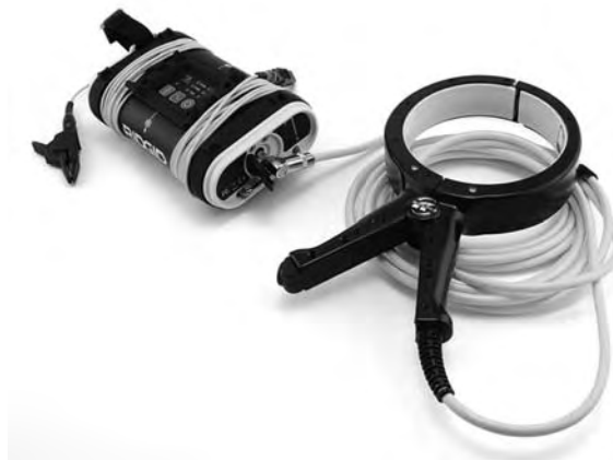
Рис. 8: Прибор ST-305 с индукционным зажимом
