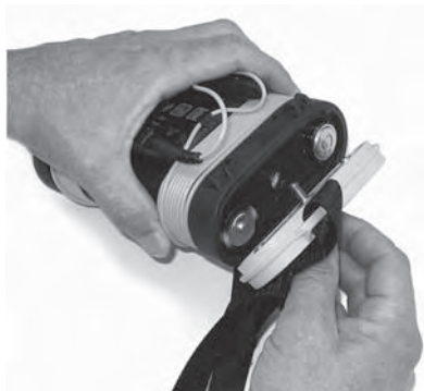
Рис. 3: Снятие крышки с отсека батарей
